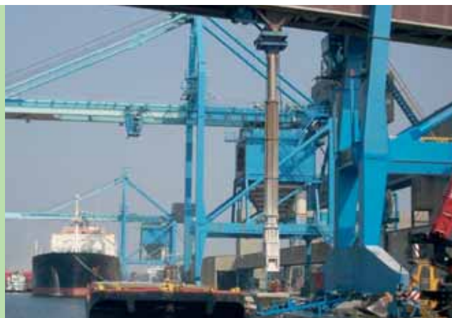
Ci-dessus : Goulotte de la série T illustrée complètement allongée
