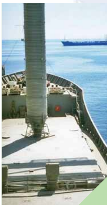
Ci-dessus : La goulotte Cemglide conçu pour un chargement sur écouteille fermée de matériaux en chute libre tels que le ciment
