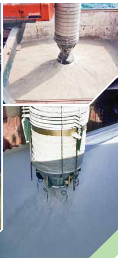
Ci-dessus à gauche : Le système Cascade monté sur un chargeur de navire maniant du soufre. Ci-dessus à droite : Le système Cascade chargeant de l'alumine dans la cale d'un navire sans produire de poussière. En haut à droite : Chargement de ciment par une écoulite ouverte.
