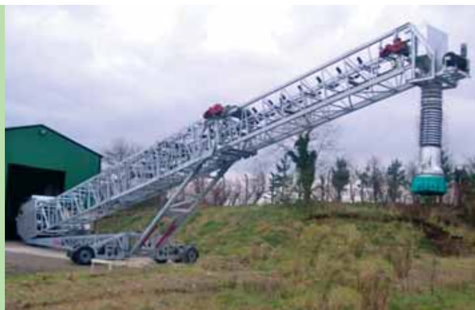
Ci-dessus : Goulotte à chute libre montée sur un transporteur à bande mobile télescopique radial utilisé pour le gerbage et le chargement des navires
