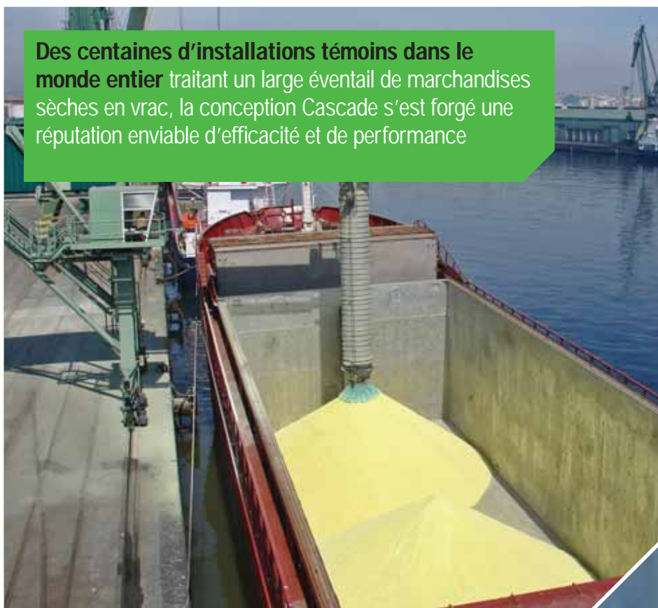
Ci-dessus à gauche : Le système Cascade monté sur un chargeur de navire maniant du soufre. Ci-dessus à droite : Le système Cascade chargeant de l'alumine dans la cale d'un navire sans produire de poussière. En haut à droite : Chargement de ciment par une écoulite ouverte.
