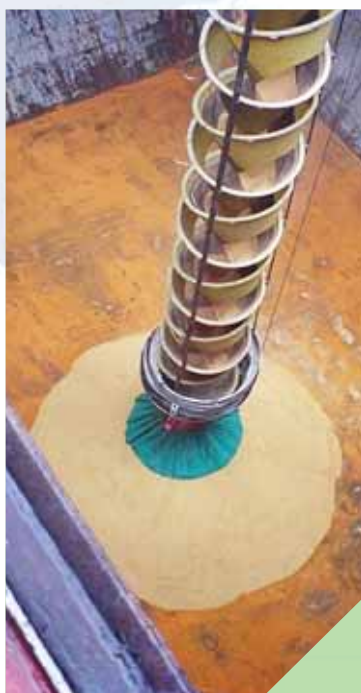
Ci-dessus : Des jupes souples assurent l'étanchéité à la sortie de la goulotte (chemise enlevée montrant le débit des matériaux)
